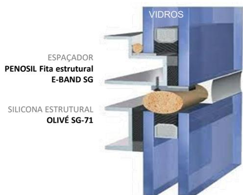
A PENOSIL Fita estrutural E-Band SG é um espaçador para aplicações de dois e quatro lados em sistemas de Vidro Estrutural.
